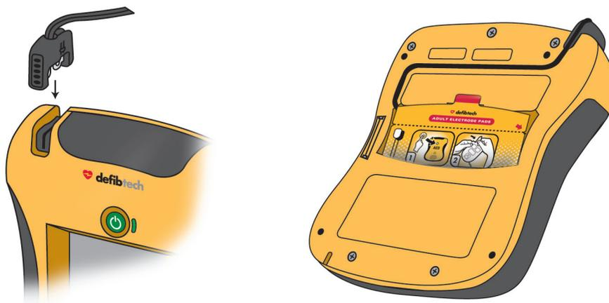
**步驟 1：檢查電擊貼片** – 首先，檢查以確保電擊貼片包裝未過期（請參見第3.2節中的圖）。請勿使用過期電擊貼片。丟棄過期電擊貼片。接下來，檢查以確保電擊貼片包裝沒有被撕開、打開或損壞。若包裝打開或損壞，則丟棄電擊貼片。檢查電擊貼片纜線，若發現纜線有任何划痕、割痕或斷裂，請更換電擊貼片。
