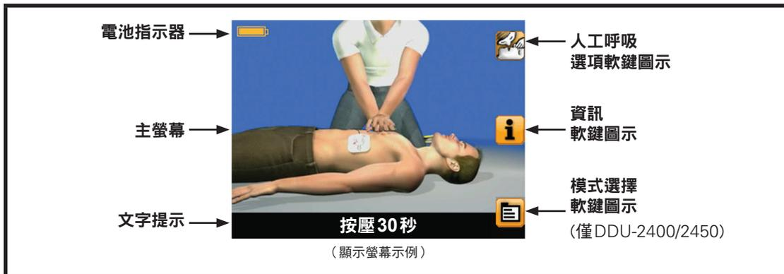
**電池指示器** – 電池指示器指示大約剩餘的電池容量
