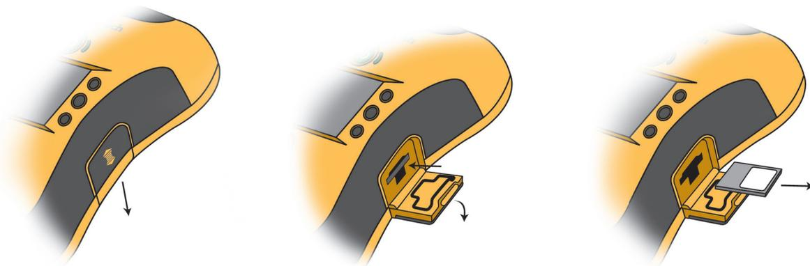
要取下 DDC 卡，請確保 AED 已關閉。在除顫器右側找到資料卡/USB 連接埠槽門。輕輕推動資料卡/USB 連接埠槽門，然後將門向下滑動，鬆開門門，即可打開槽門。門將彈開。要取下 DDC 卡，請將卡向內按到底，然後鬆開。鬆開後，DDC 卡將部分彈出，然後拉出 DDC 卡的剩餘部分即可取出。
