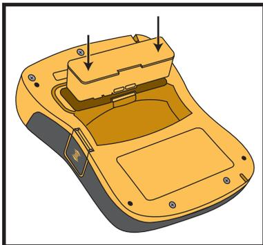
如左圖所示，將電池組插入DDU-2000系列AED中之前，請確保AED背面的電池組開口乾淨且無任何異物。將電池組插入AED背面的開口中。將電池組完全推入，直到門鎖發出咔聲。電池組將僅適合一種方式 - 若電池組不合適，請在再次嘗試之前旋轉電池組。完全插入後，電池組表面應與AED的背面齊平。
