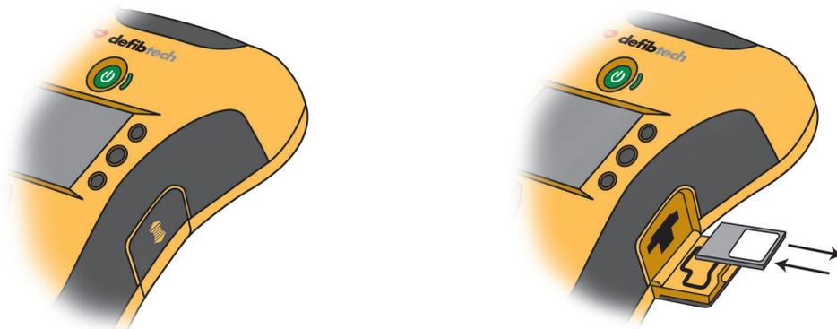
安裝 DDC 卡之前，請確保 AED 已關閉。在除顫器右側找到資料卡/USB 連接埠槽門。輕輕推動資料卡/USB 連接埠槽門，然後將門向下滑動，鬆開門門，即可打開槽門。門將彈開。將 DDC 卡插入 AED 側面 USB 連接埠開口正中心的細卡槽 (先插入有槽口的一端，有標示的一面朝上)，直至其卡入到位。卡應與卡槽表面齊平。若卡未完全插入，則可能是顛倒插入了卡。在這種情況下，請取出卡，將其翻轉，然後嘗試再次插入。
