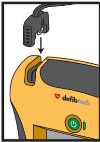
將除顫電擊貼片纜線的連接器端插入DDU-2000系列AED左上角的電擊貼片連接器插座，如左圖所示。用力插入電擊貼片連接器，直至其完全固定在除顫器中。連接器將僅適合一種方式 - 若連接器不合適，請在再次嘗試之前旋轉連接器。
