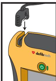
將電擊貼片連接到除顫器(若尚未連接)。遵從AED語音和顯示指示。DDU-2000系列AED設計為存放時除顫電擊貼片連接器連接到除顫器上，而電擊貼片本身仍密封在其包裝中。這減少了在緊急情況下設定和開始治療所需的時間。
