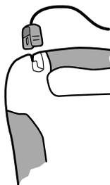
Introduire l'extrémité du connecteur du câble des électrodes de défibrillation dans la prise femelle des électrodes située dans le coin supérieur gauche du DAE, comme sur l'illustration à gauche. Introduire le connecteur d'électrodes fermement jusqu'à ce qu'il soit complètement enfoncé dans l'appareil.
