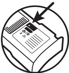
電池組的使用中狀態指示燈（「ASI」）位於電池組上印有標籤的那一面，可用於顯示電池組的狀態。LED 規律地閃綠燈表示電池組狀態正常，隨時可供使用。LED 若未閃綠燈，表示電池組故障或沒電，或者未裝入 9 伏特電池。如需有關電池組 LED 指示的詳細資訊，請參閱「檢查 *DDU-100* AED 狀態」一節。
