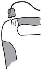
DDU-100 AED 的設計可用於收納已與機器連接的電擊墊，但電擊墊本身仍密封於包裝袋中。一旦需要急救時，這種設計能夠在最短的時間內完成設定並開始治療。保存 Defibtech AED 時，請勿拔下插在機器中的電擊墊接頭。然而，若電擊墊已受損或未接受，急救時可能需要更換一組新電擊墊。電擊墊接頭位於 AED 的角落。
