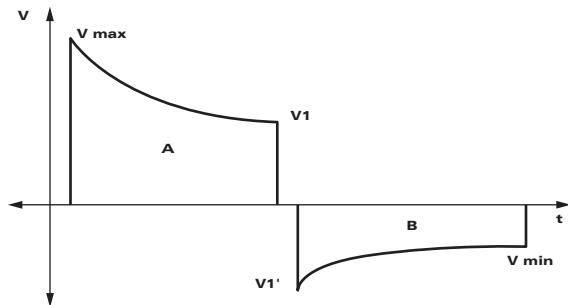
可調整波形以抵銷測得的病者阻抗。下表顯示標稱相位時間和所傳導的能量。
