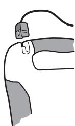
DDU-120 AED 的設計可用於收納已與機器連接的電擊墊，但電擊墊本身仍密封於包裝袋中。一旦需要急救時，這種設計能夠在最短的時間內完成設定並開始治療。保存 Defibtech AED 時，請勿拔下插在機器中的電擊墊接頭。然而，若電擊墊已受損或未接妥，急救時可能需要換用一組新電擊墊。電擊墊接頭位於 AED 的角落。
