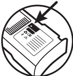
電池組的使用中狀態指示燈（「ASI」）位於電池組上印有標籤的那一面，可用於顯示電池組的狀態。LED 規律地閃綠燈表示電池組狀態正常，隨時可供使用。LED 若未閃綠燈，表示電池組故障或沒電，或者未裝入 9 伏特電池。如需有關電池組 LED 指示的詳細資訊，請參閱「檢查 DDU-120 AED 狀態」一節。
