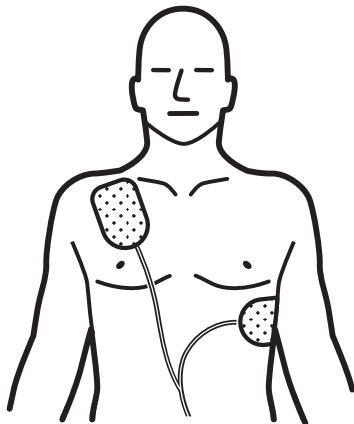
**成人及 8 歲以上兒童需使用成人專用電擊墊：**如圖片所示，將其中一片電擊墊貼在病者右鎖骨正下方。將第二片電擊墊貼在病者左側肋骨上方、左乳以下的位置，亦請參考圖示。
