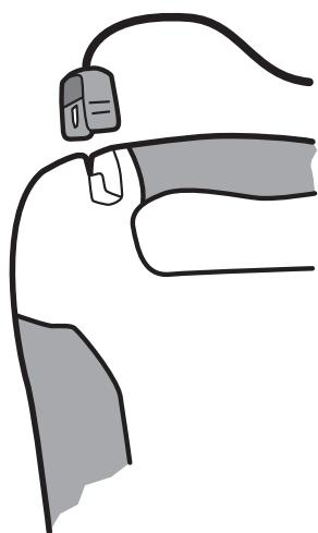
*DDU-120 AED* 去顫/監控電擊墊均密封於包裝袋內，接頭和部分纜線會露在包裝袋外。這樣可以預先連接電擊墊，需要急救時即可快速部署。
