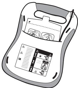
之後即可將電擊墊包收納在 *DDU-120 AED* 後方的 電擊墊收納插槽中。將電擊墊接頭插入機器後，將電擊墊包印有圖片的那一面朝上並朝外、圓角端朝內，推入 *AED* 後方的電擊墊固定槽內。將電擊墊包完全推入後，將電擊墊纜線塞入機器後方的溝槽內加以固定，然後將多餘的纜線塞入電擊墊包的後面。
